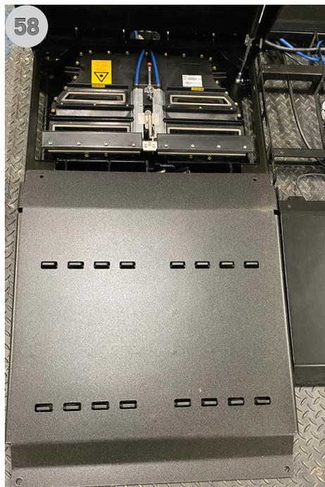
26. Zum Schließen des Deckels des Sensorgehäuses am Stift an der Sicherheitsverriegelung ziehen.
