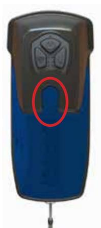
Lo scanner dispone di una batteria ricaricabile agli ioni di litio integrata, ricaricabile per mezzo del caricatore USB da 5 VDC 2 A in dotazione. Uno scanner completamente carico di norma ha un'autonomia di una giornata lavorativa intera. Per controllare il livello della batteria, tenere premuto il pulsante batteria per 1 secondo. Lo stato della batteria viene quindi visualizzato come verde, giallo o rosso.
