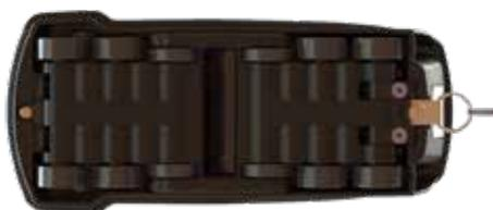
Per pulire la finestra ottica, sbloccare il gruppo rotelle sul lato inferiore dello scanner premendo le due clip di ritenuta. In tal modo, il gruppo rotelle si stacca dalla base dello scanner ruotando su un cardine.
