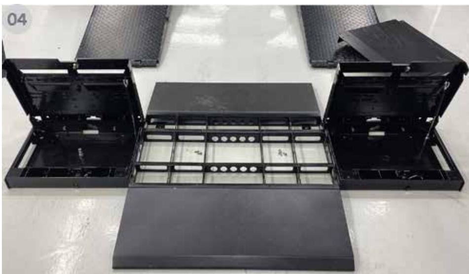
9. Alinee la clavija con la apertura en la sección central. Deje espacio para que la tapa se cierre y no golpee la sección central.
