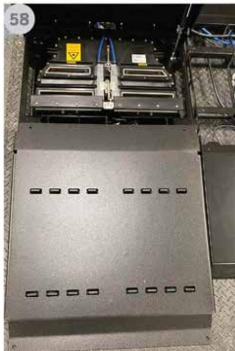
26. Para cerrar la tapa del alojamiento del sensor, debe estirar de la clavija en el pestillo de seguridad.
