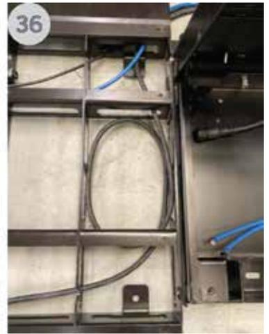
21. El cable de 2,5 m desde el alojamiento del sensor derecho al alojamiento del sensor izquierdo. La conexión hembra a la izquierda, la conexión macho a la derecha
